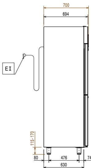
EI = Conexión eléctrica (energía)
